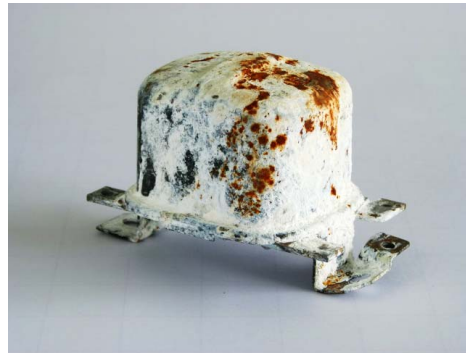
im Test: 15 Jahre Korosion
